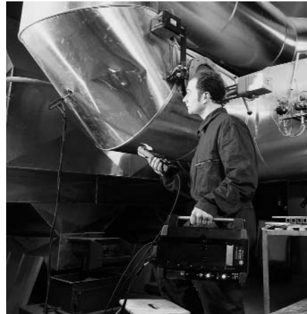
Bild 6.12: Abgasmessung (Werksbild Testo AG)
